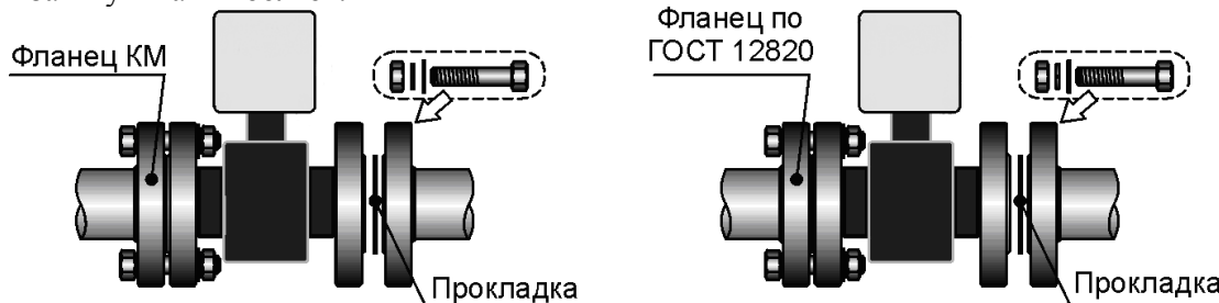
Рисунок 5.9 – Варианты монтажа ИТЭМ фланцевого исполнения
